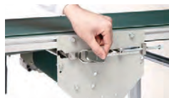
①底面カバーをはずし、 パッチン錠をはずす
