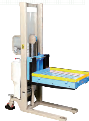
昇降機能付き金型交換台車 最大積載量:~700Kg
