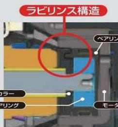
鉄粉によるモーターコイルへの傷を防ぐ
