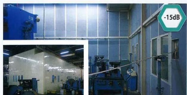
大型プレスラインの場合、プレス本体に防音壁・シャッターを取り付け、入口・出口部に防音カバーを設置します。中・小型プレス機では設備全体を防音室内に納めます。中・小型プレス機が多数・集中して設置されている場合、個別に対策を行うよりも1つの防音室に納めた方が、効率良く騒音対策を行うことができ、さらに作業性・メンテナンス性も良好となります。
