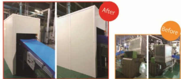
パネル+樹脂フレーム別注品 (ブロー成形品用粉碎機騒音対策用)
