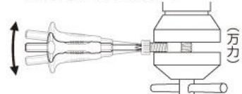
プライヤーやペンチで外せない場合は万力でしっかりとネジを挟み、ネジとリビットを上図矢印のように反復移動させて外してください。
