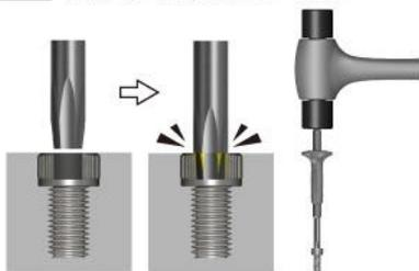
初めにハンマーでネジとリビット後端を叩き、なめたネジに刃先を垂直に喰い込ませます。
