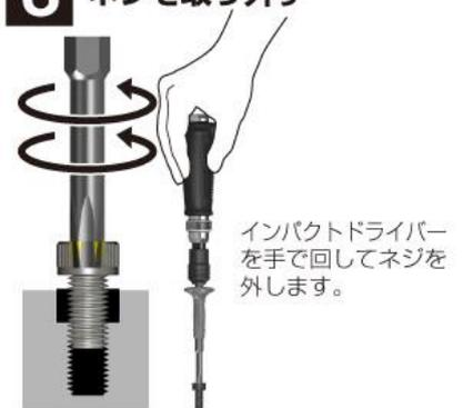
インパクトドライバーを手で回してネジを外します。
